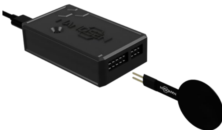
Électronique de lecture avec un capteur de force PNC
