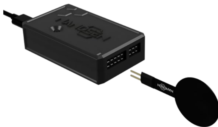
Ausleseelektronik zum Anschluss an einen PNC-Kraftsensor
